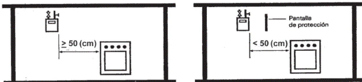
Figura 17. Distancia de seguridad con pantalla de protección.
